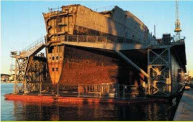
Navire en cours de démantèlement sur dock flottant au port de Brégaillon
