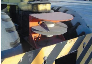
Dispositif permettant d'éviter la collision des machines avec les conteneurs
