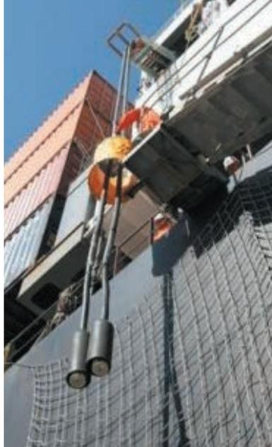
Cablage destiné au "cold ironing" pour l'alimentation en électricité d'un navire
