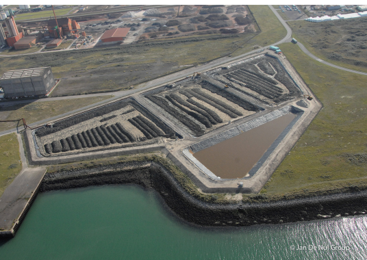
Traitement à terre des sédiments de dragage à Dunkerque/France
