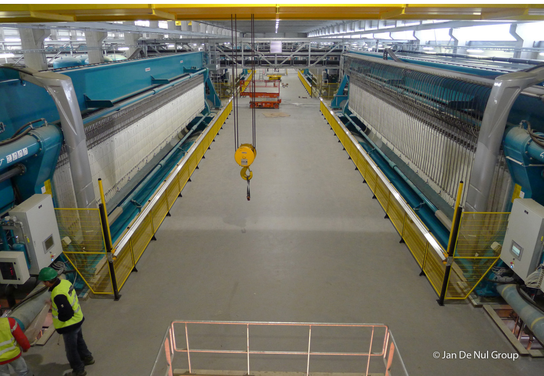
Filtres presse plateforme AMORAS - Port d'Anvers/Belgique
