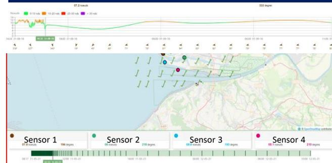
Prévisions combinées aux mesures prises sur site dans un même outil, jusqu'à 8 miles nautiques au large. Carte et séries temporelles de la vitesse et direction du vent, en temps réel et jusqu'à 72h en prévisionnel.
